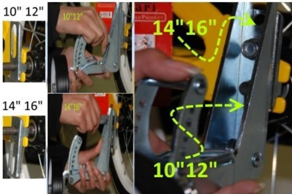
ATENCIÓN: ANTES DE INSTALAR EL DE-ESTABILIZADOR HAY QUE CARGAR EL RESORTE(STEP 1). EN LA BICICLETA 14 ' LA RUEDA SE QUEDARA' LEVANTADA , Y BAJO EL PESO DE LA NINA/ O (PASO 2) VA ADHERIENDO AL SUELO A TRAVES EL RESORTE AJUSTADO (STEP 2 )
