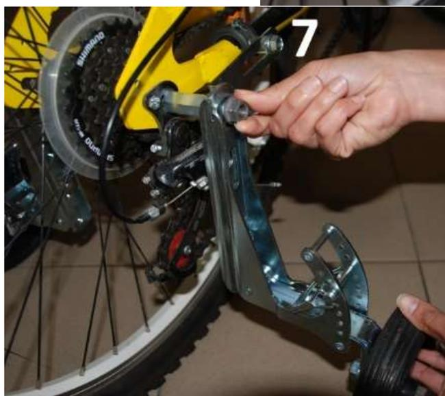
**(7) ASSICURARSI CHE LE GLI STWHEELS ABBIANO IL PERNO DI REGOLAZIONE AL PRIMO BUCO, OSCILLAZIONE DELLA BICICLETTA AL MINIMO COME DA (STEP (1) DELLE ISTRUZIONI). POSIZIONARE LA BICICLETTA PERPENDICOLARE AL PAVIMENTO. ACCERTARSI CHE LA RUOTA DELLA BICICLETTA E LE RUOTE DEGLI EROGATORI D'EQUILIBRIO TOCCHINO CORRETTAMENTE A TERRA E SERRARE BENE TUTTE LE VITI (FOTO 8-9-10-11):**
